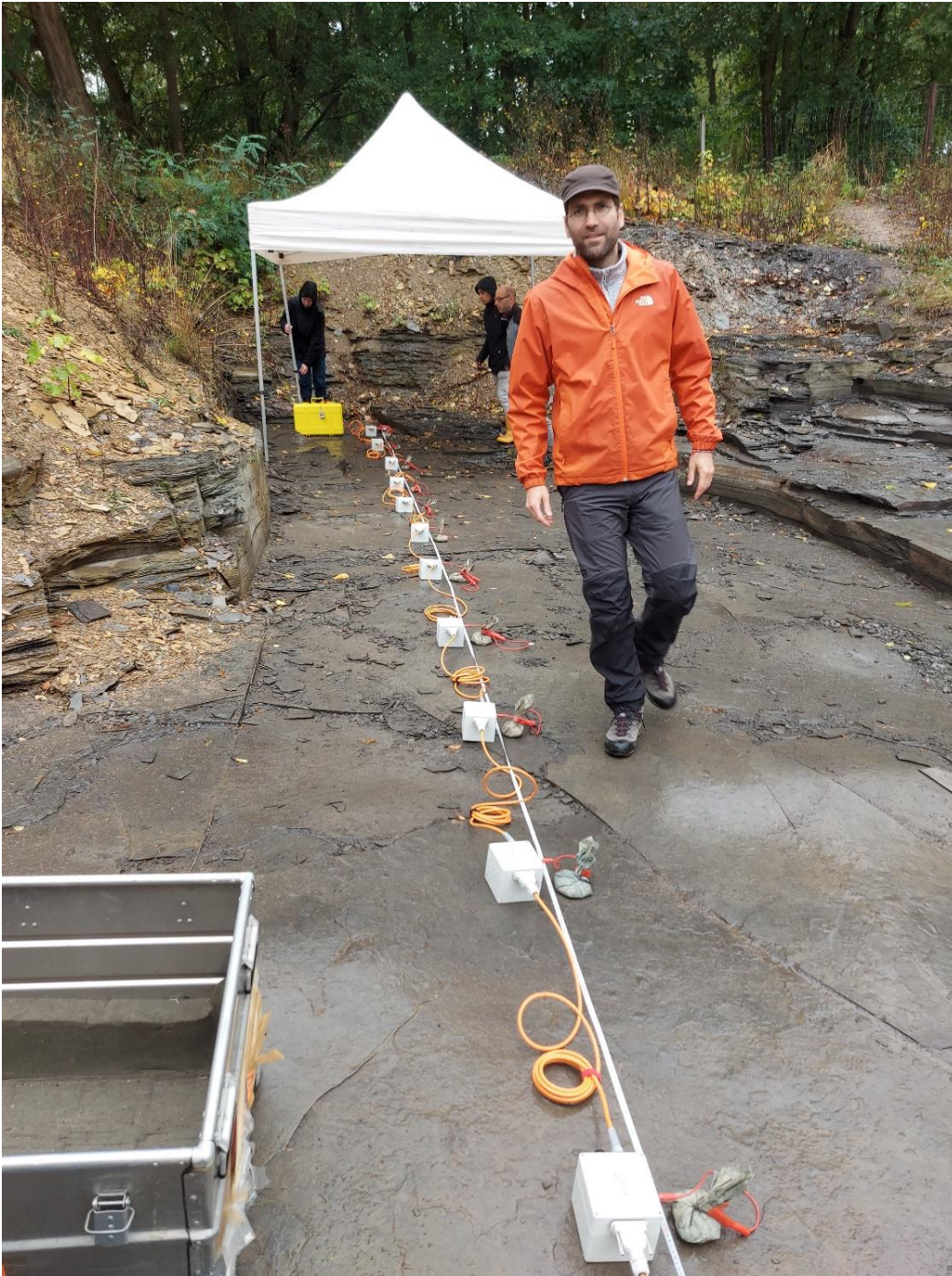
Abb. 8: Geophysikalische Widerstandsmessungen am 27.09.2022 auf der südlichen Grabungsfläche durch das Institut für Geophysik und extraterrestrische Physik (IGEP) der Technischen Universität Braunschweig. (Foto: Ralf Kosma)
