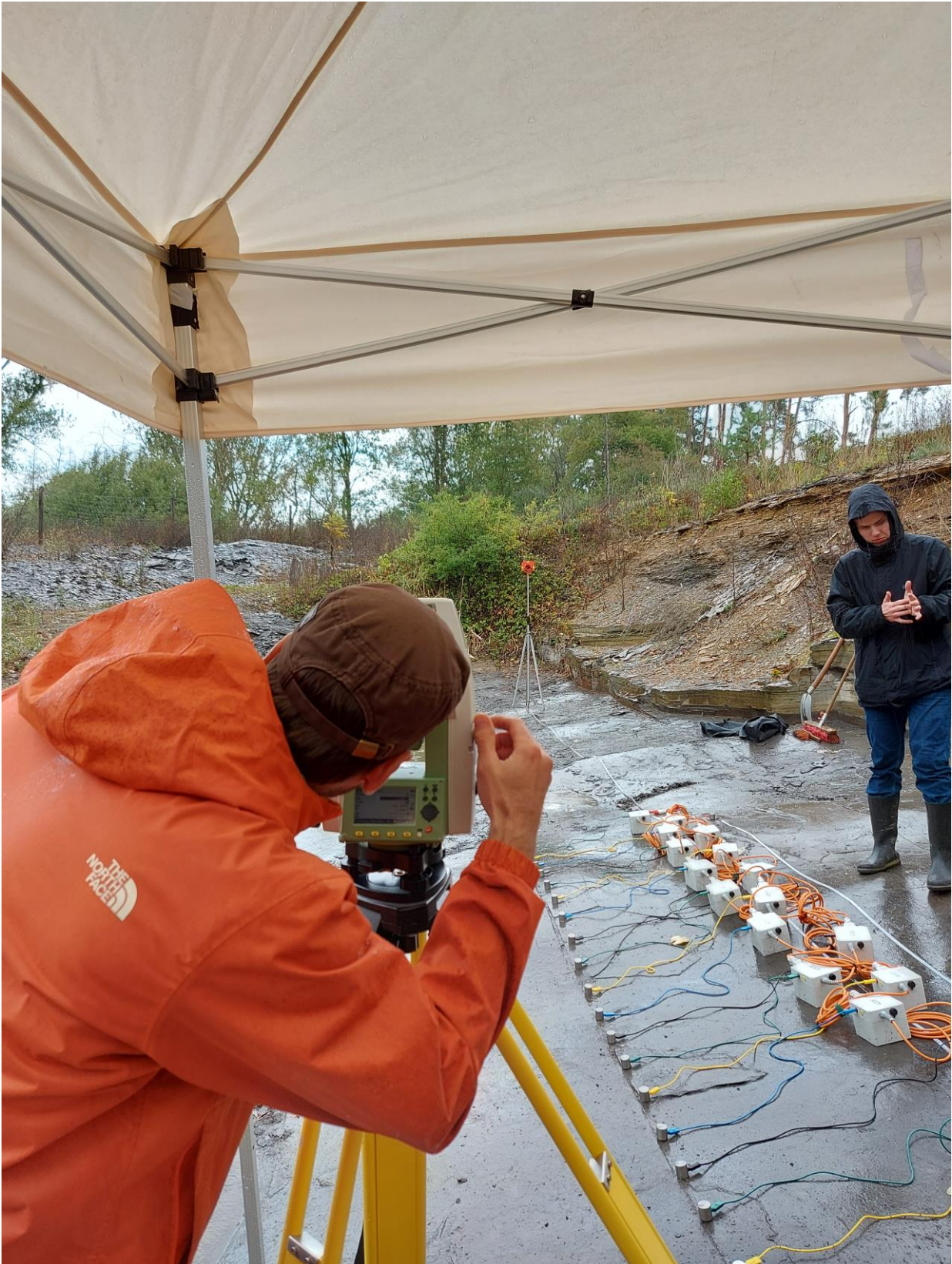
Abb. 11: Das regnerische Wetter am Untersuchungstag ist sehr willkommen, da Wasser das Gestein durchtränkt und die Leitfähigkeit für die elektrischen Impulse erhöht. (Foto: Ralf Kosma)
